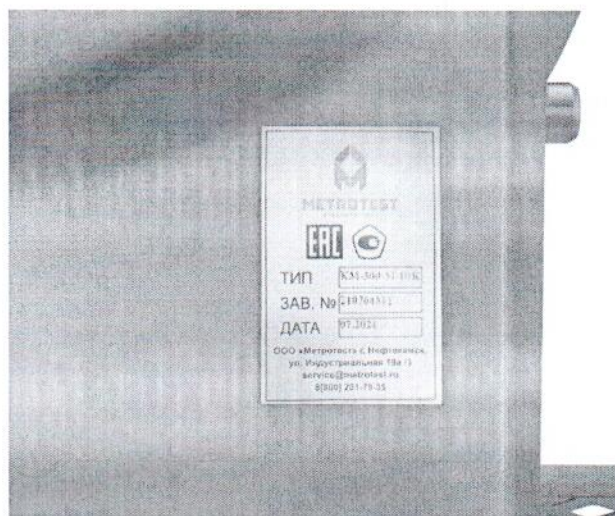
Рисунок 9 – Общий вид маркировочной таблички копров маятниковых КМ
