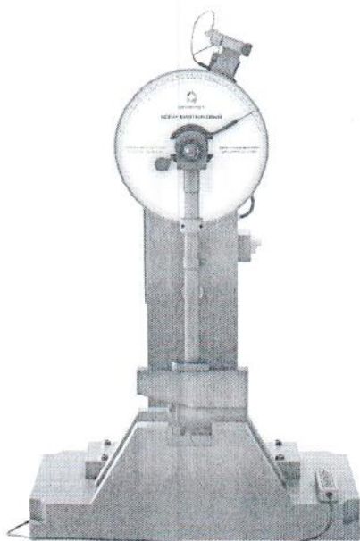
Рисунок 6 – Общий вид копиров маятниковых: КМ-150(250/300/450/500/750/900)-М-Ш; КМ-150(250/300/450/500/750/900)-М-ПУ; КМ- 150(250/300/450/500/750/900)-М-К
