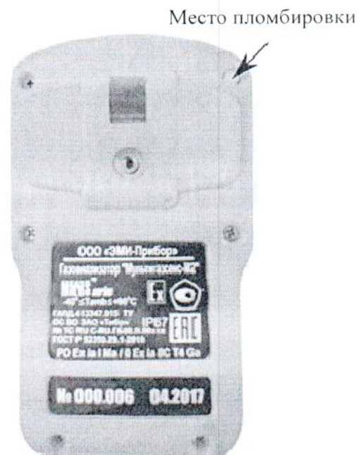
Рисунок 2 – Схема пломбировки от несанкционированного доступа МУЛЬТИГАЗСЕНС-М2
