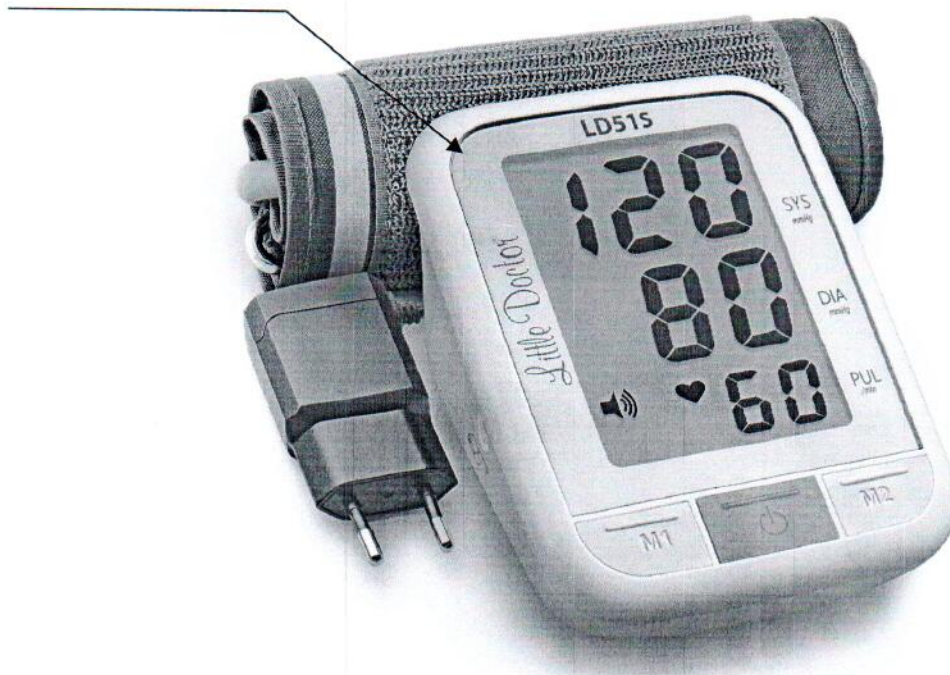
Рисунок 2.9 – Схема (рисунок) с указанием места для нанесения знака поверки на измеритель артериального давления автоматический (прибор для измерения артериального давления и частоты пульса цифровые) LD51S
