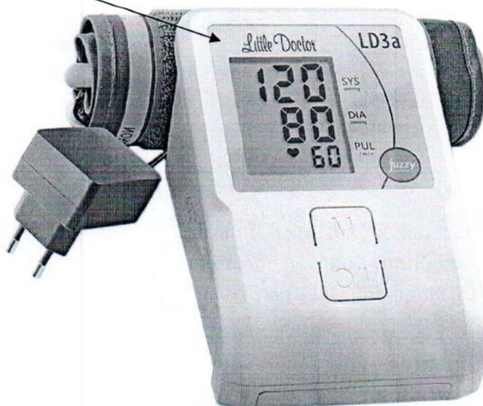
Рисунок 2.2 – Схема (рисунок) с указанием места для нанесения знака поверки на измеритель артериального давления автоматический (прибор для измерения артериального давления и частоты пульса цифровые) LD3a
