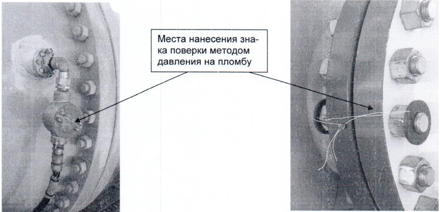
Рисунок 2.2 – Места для нанесения знака поверки средства измерений
