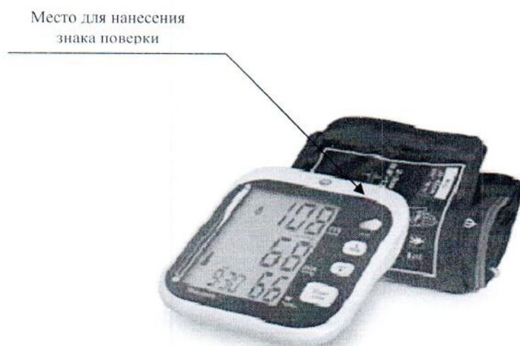
Рисунок 2.2 – Схема (рисунок) с указанием места для нанесения знака поверки измерителя maxIRapid
