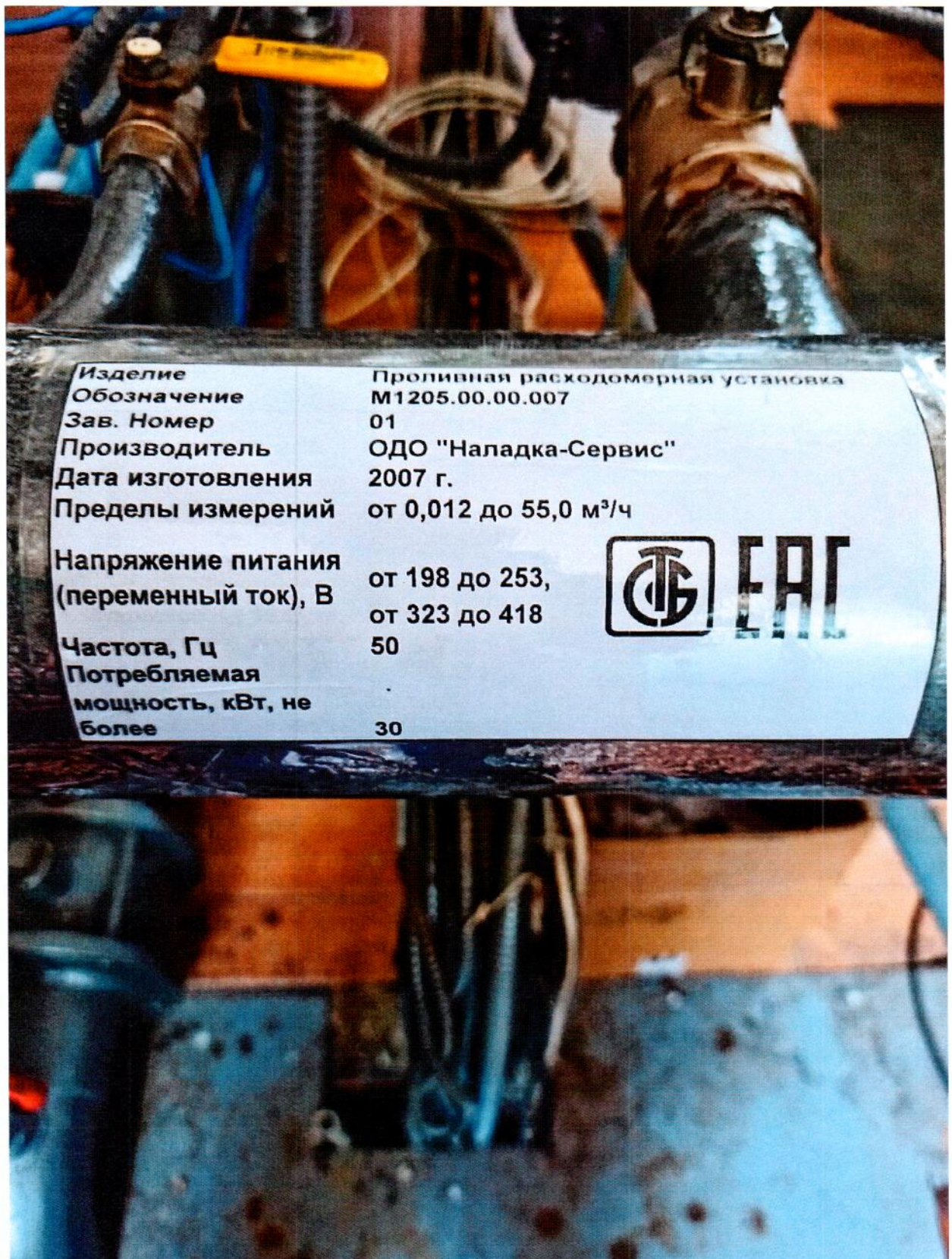
Рисунок 1.2 – Фотография маркировки проливной расходомерной установки M1205.00.00.007 № 01
