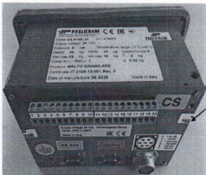
Схема пломбировки электронного блока управления «CS-A» от несанкционированного доступа
