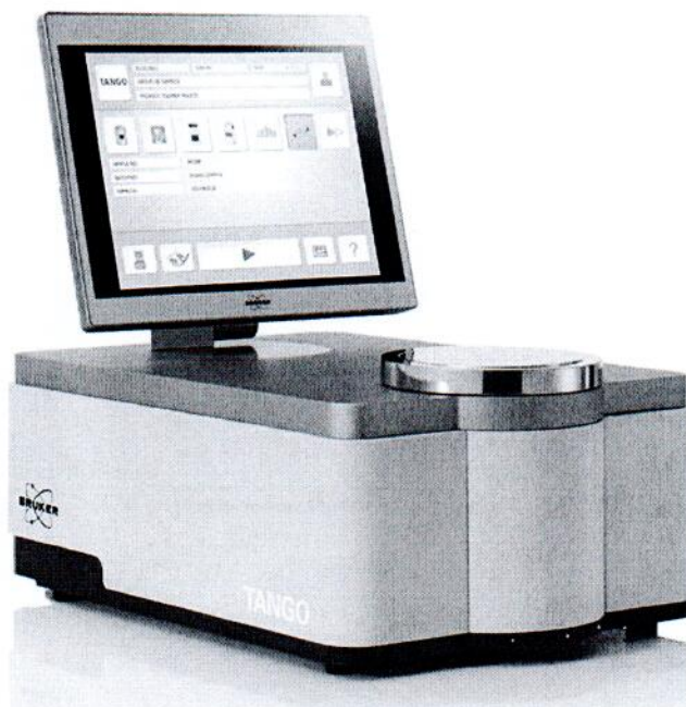
Рисунок 1.1 – Фотография общего вида Фурье-спектрометров инфракрасных TANGO с модулем диффузного отражения “фотометрический шар” (изображение носит иллюстративный характер)
