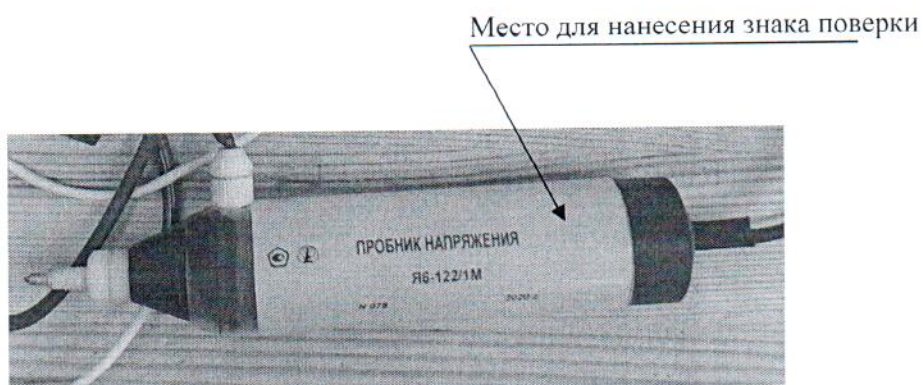
Рисунок 2.1 - Место для нанесения знака поверки
