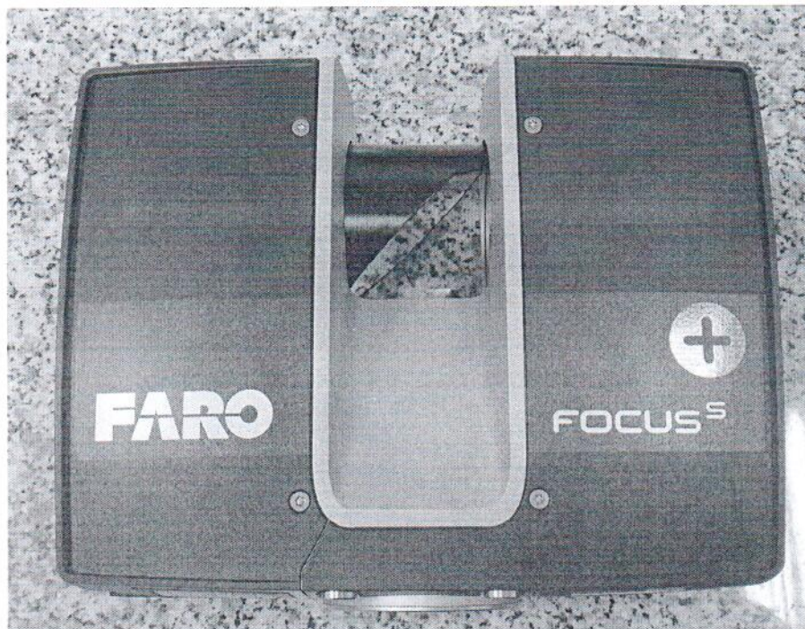
Рисунок 1.1 – Фотография общего вида лазерного сканера FARO Focus S Plus 150 № LLS082119941
