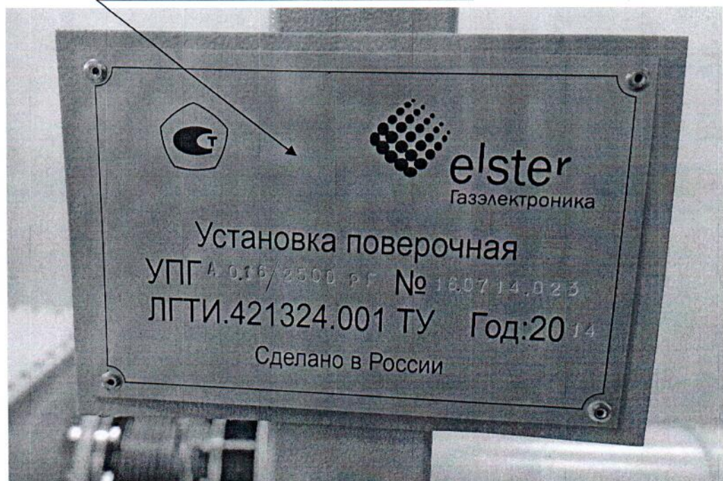
Рисунок 2.2 – Схема с указанием места для нанесения знака поверки и знака утверждения типа средств измерений
