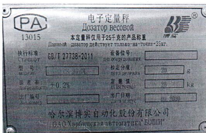
Рисунок 1.2 – Маркировка дозатора весового автоматического дискретного действия LCS-25-DL № CE19104-WCF.EA
