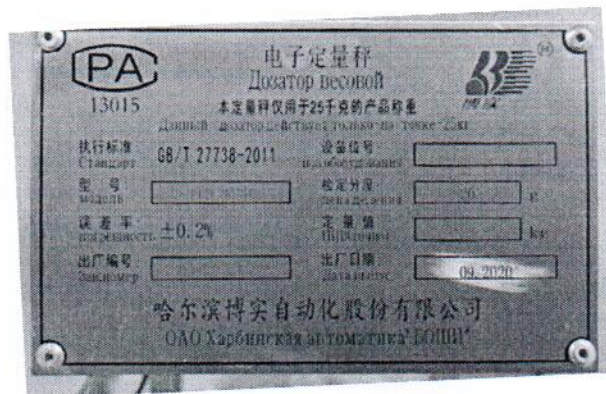
Рисунок 1.2 – Маркировка дозатора весового автоматического дискретного действия LCS-25-DL № CE19101-WCF.FC-B
