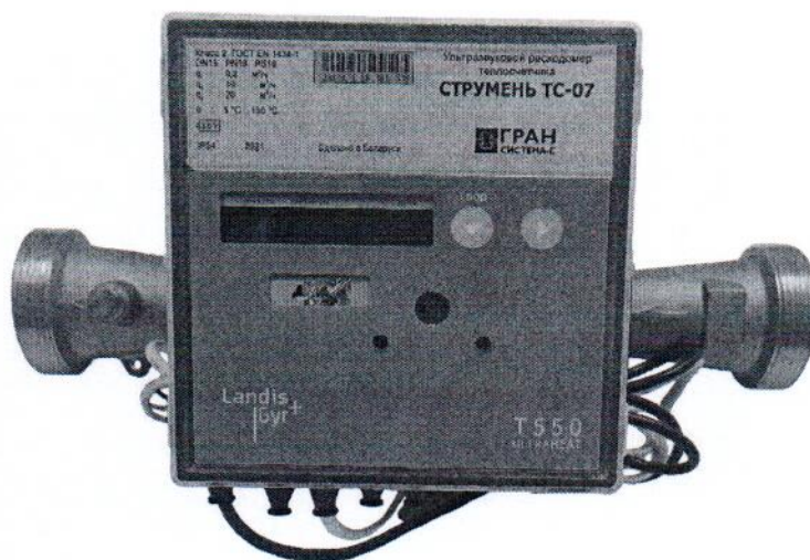
Рисунок 1.4 – Фотография общего вида ультразвукового расходомера теплосчетчика (изображение носит иллюстративный характер)
