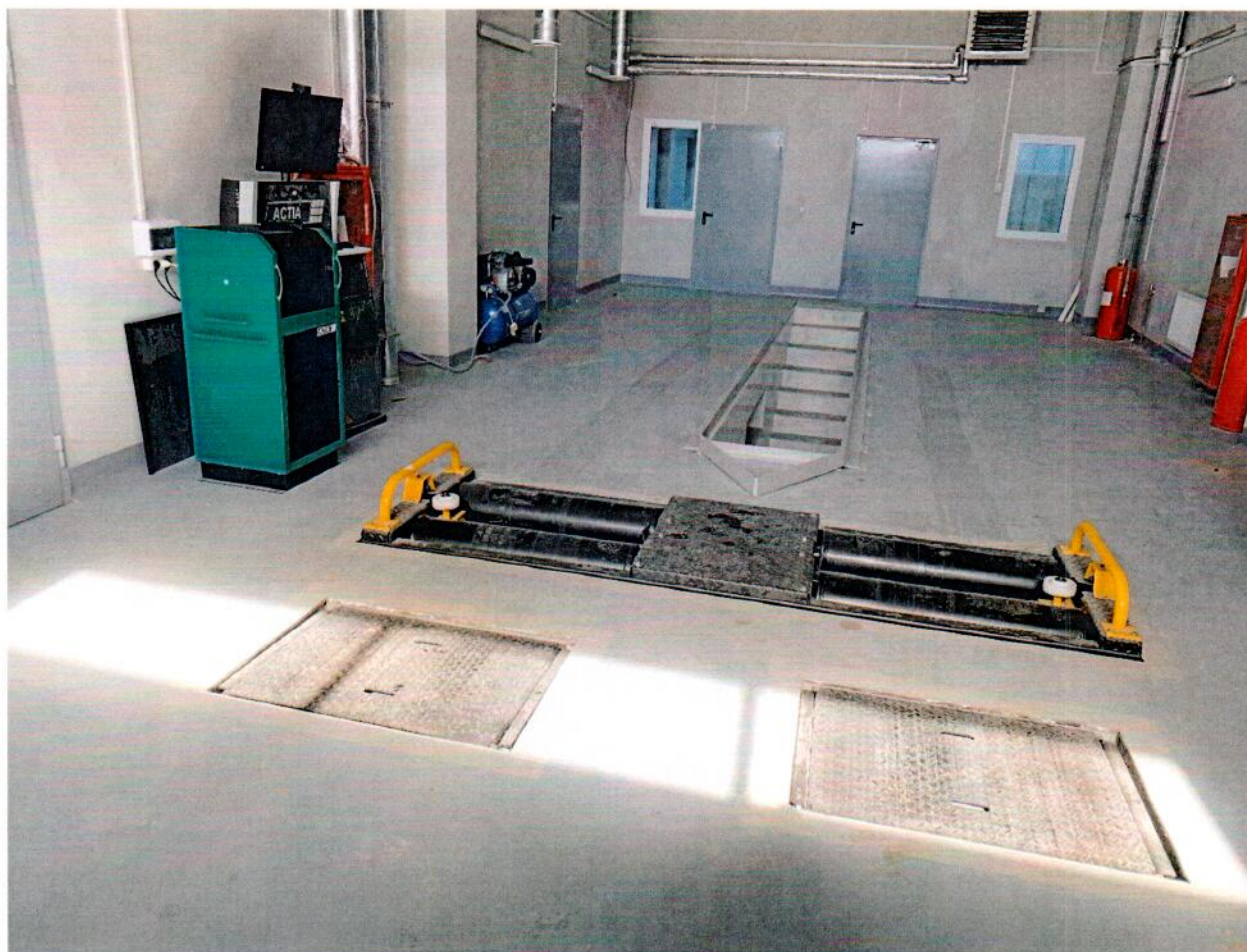
Рисунок А.1 – Общий вид станда проверки параметров тахографов, спидометров и одометров грузовых и легковых автомобилей АМ45300 – ВОХ – RU № 453130109 с прибором измерительным УТР-10.
