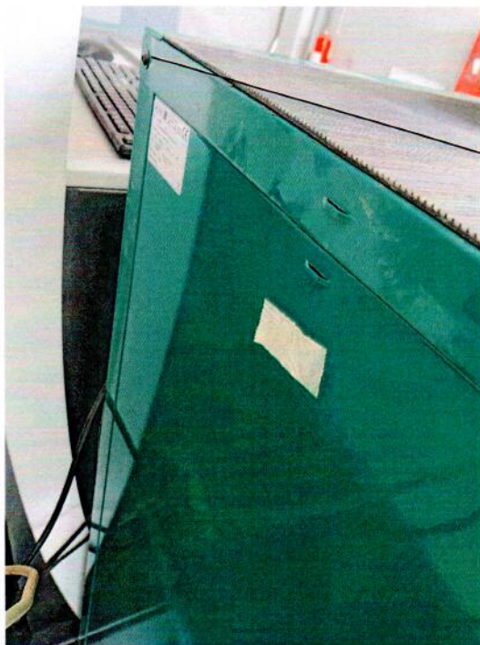
Рисунок В.2 – Схема пломбировки для защиты от несанкционированного доступа внутрь корпуса прибора
