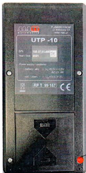
Рисунок В.1 – Схема пломбировки для защиты от несанкционированного доступа внутрь прибора UTP-10
