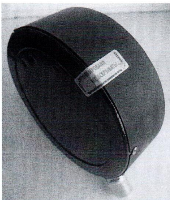
Рисунок 7 – Заводская пломбировка с помощью наклейки
