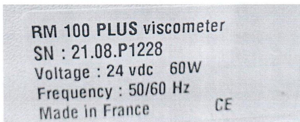
Рисунок 1.2 – Фотография маркировки ротационного вискозиметра RM 100 PLUS
