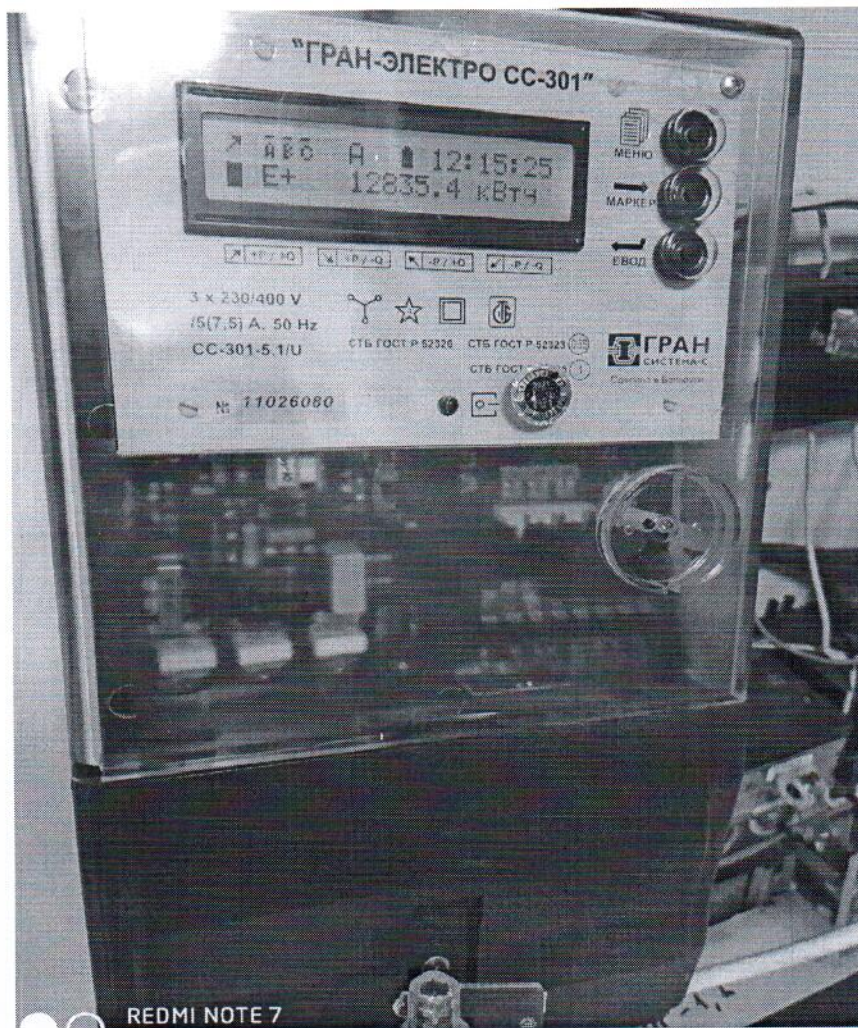
Рисунок 2 – Фотография компонентов АСКУЭ при применении счетчиков электрической энергии переменного тока трехфазных статических СС-301
