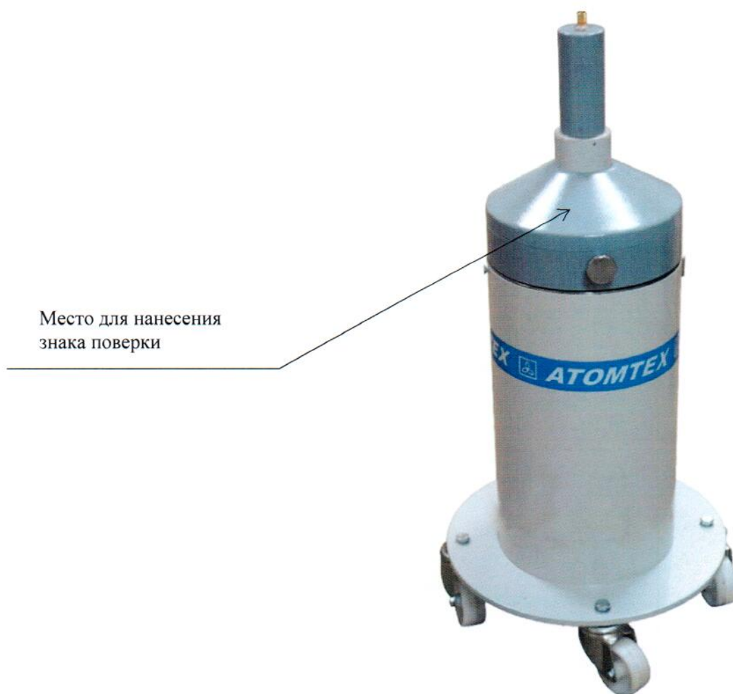
Рисунок 2.1 – Схема (рисунок) с указанием места для нанесения знака поверки на спектрометр
