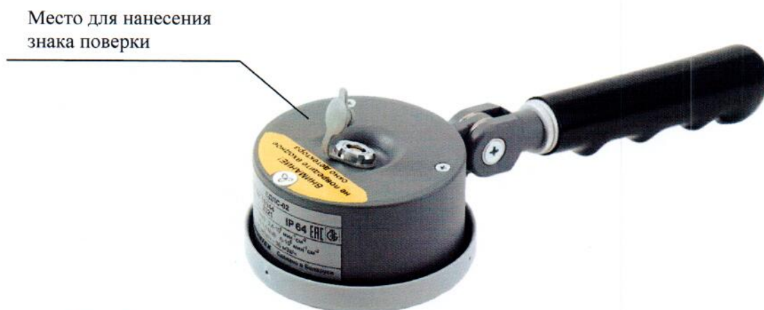
Рисунок 2.2 – Схема (рисунок) с указанием места для нанесения знака поверки на блок детектирования БДПС-02
