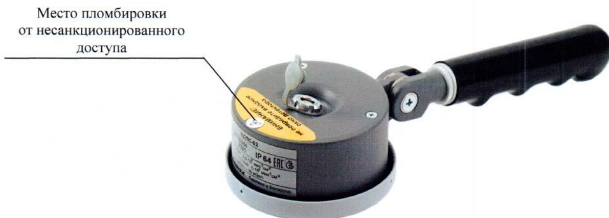
Рисунок 3.2 – Схема пломбировки блока детектирования БДПС-02 от несанкционированного доступа
