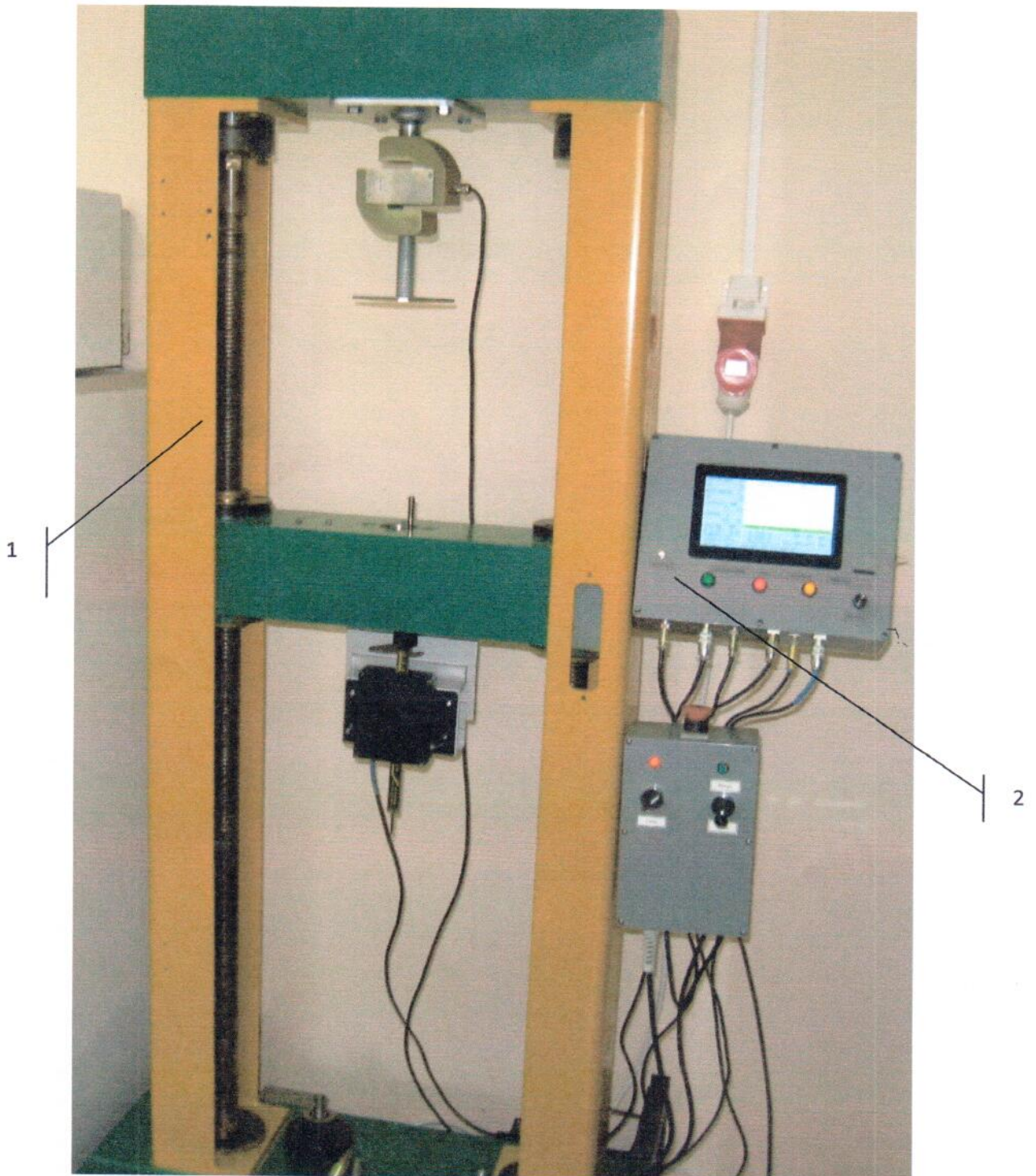
Рисунок А.1 - Внешний вид машины испытательной модернизированной Р-5М (1 – устройство нагружающее, 2 – блок управления)
