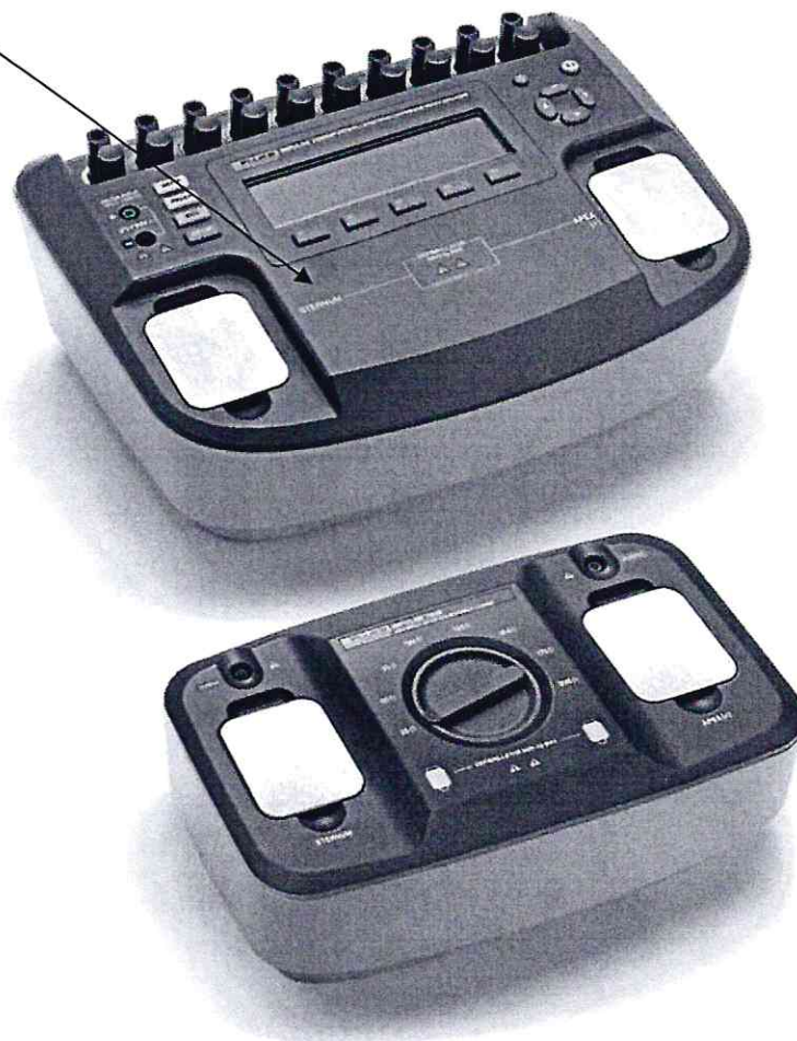
Рисунок 1 – Место нанесения знака поверки в виде клейма-наклейки на Анализатор дефибриллятора Impulse 7000DP зав. № 5528009 с блоком нагрузок Impulse 7010 зав. № 5530602
