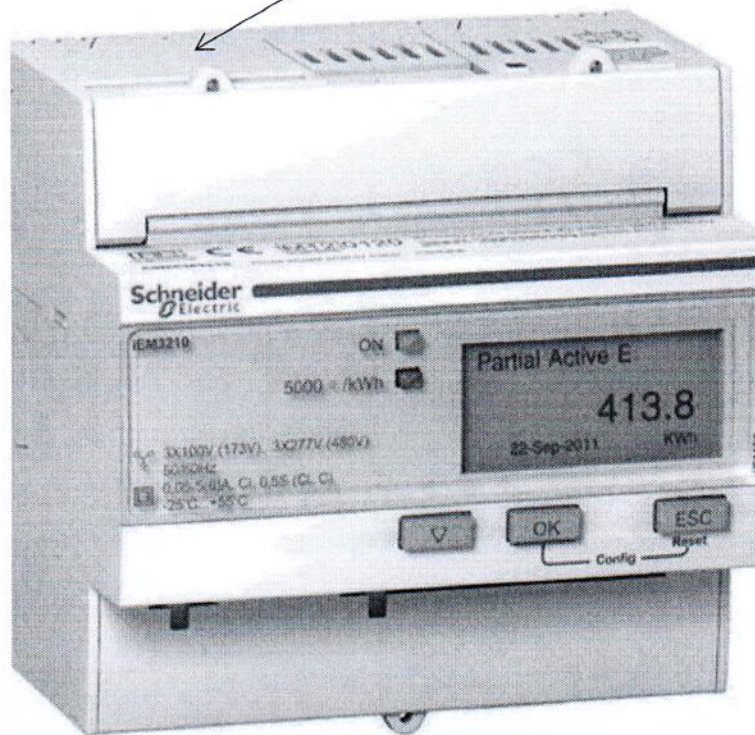
Рисунок 2.1 - Место нанесения знака поверки в виде клейма-наклейки на счетчики iEM31xx/iEM32xx
