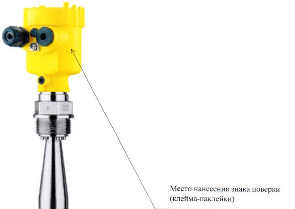
Рисунок 2 – Схема с указанием места нанесения знака поверки (клейма-наклейки)
