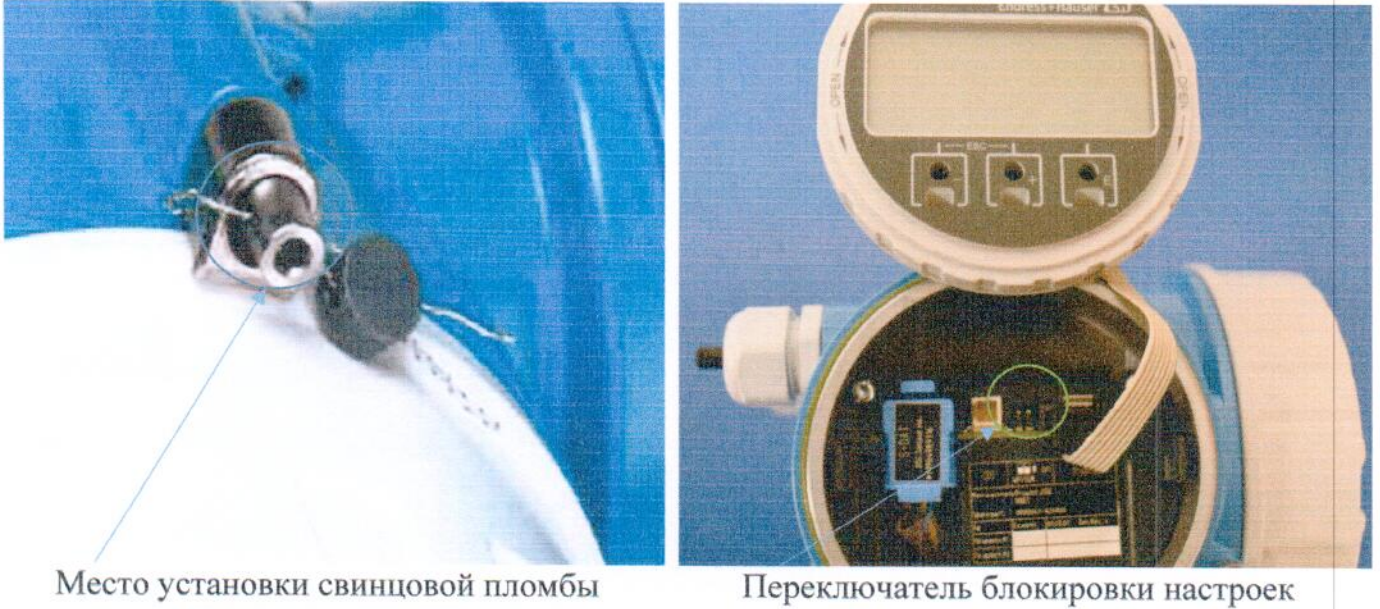
Рисунок 1 – Схема пломбировки от несанкционированного доступа
