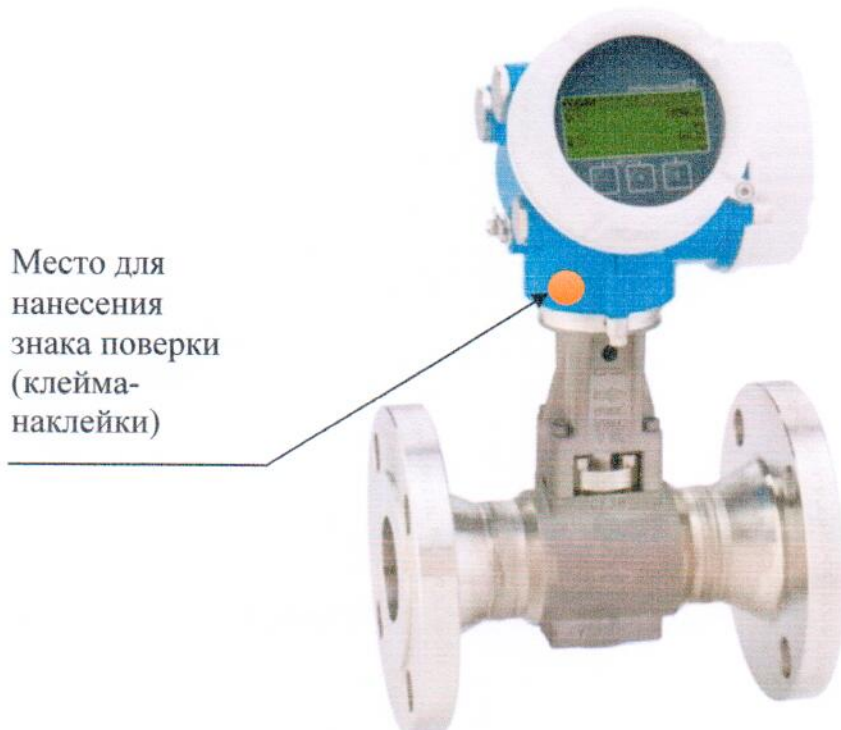
Рисунок 2 – Место для нанесения знака поверки (клейма-наклейки).
