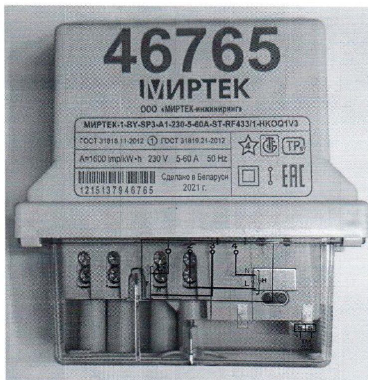
Рисунок А.3 - Внешний вид счетчика в корпусе модификации SP3
