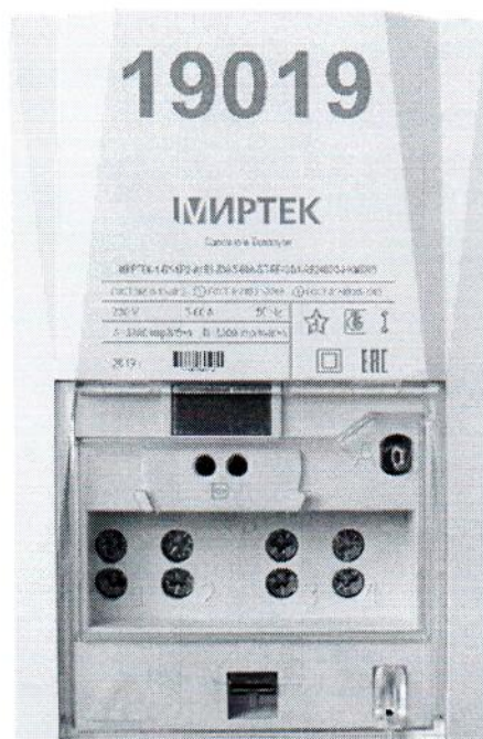
Рисунок А.2 – Внешний вид счетчика в корпусе модификации SP2
