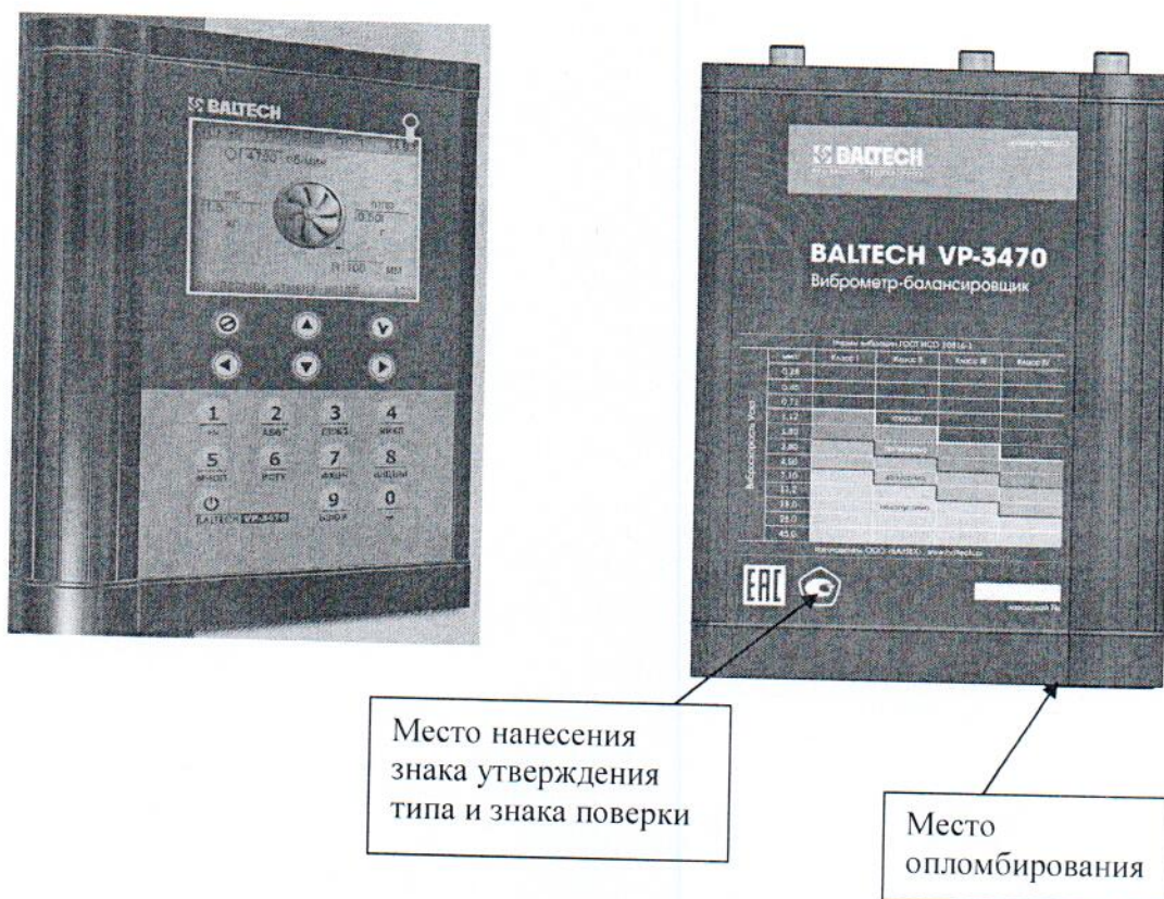
Рисунок 2 – Общий вид вычислительного блока виброметра BALTECH VP-3470
