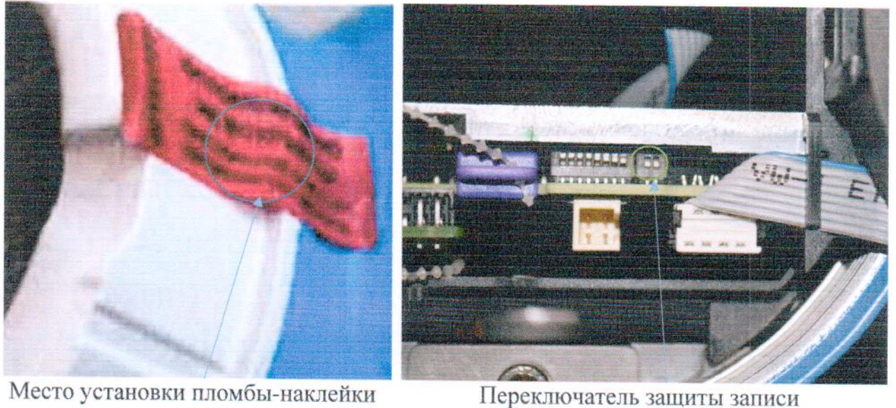
Рисунок 1 – Схема пломбировки расходомера
