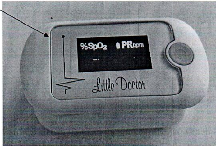
Рисунок 1 – Место нанесения знака поверки в виде клейма-наклейки
