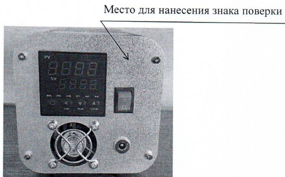
Рисунок Б.1 - Место нанесения знака поверки в виде клейма-наклейки
