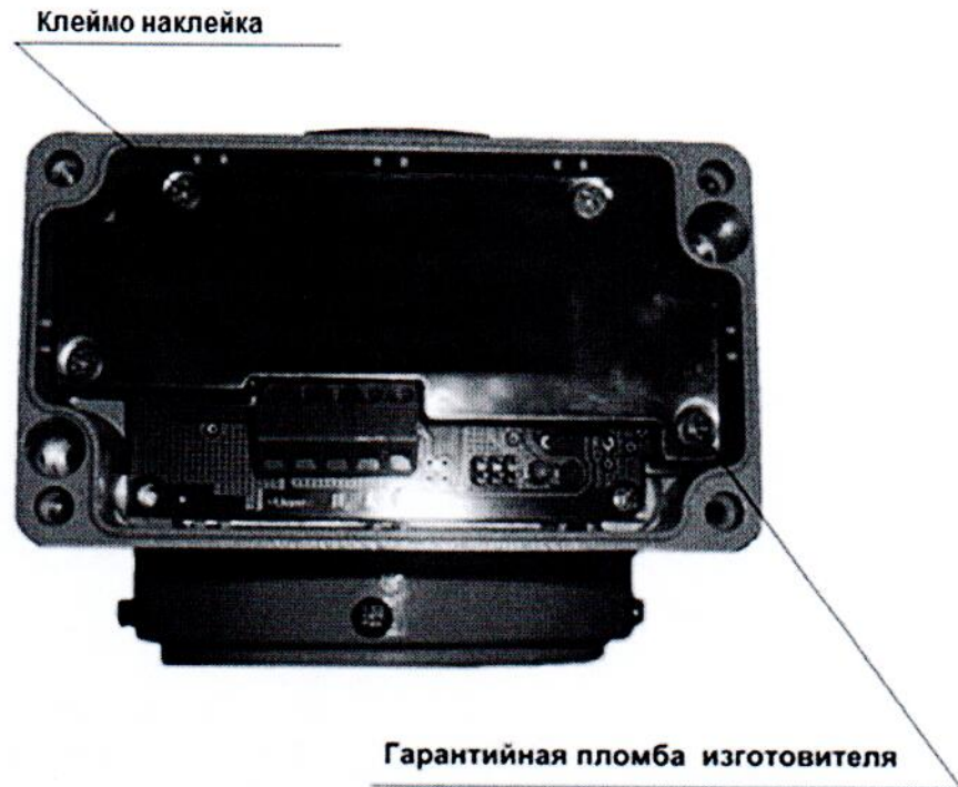
Рисунок Б.1 - Место нанесения знака поверки в виде клейма-наклейки
