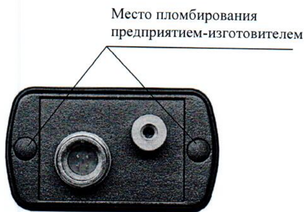
Рисунок 2 — Схема пломбировки от несанкционированного доступа
