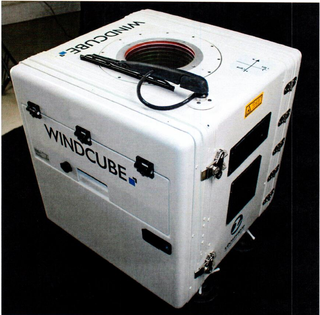
Рисунок А.1 – Внешний вид прибора для измерения параметров ветра типа лидар WindCube Vertical Profiler, зав. № WLS7-1345
