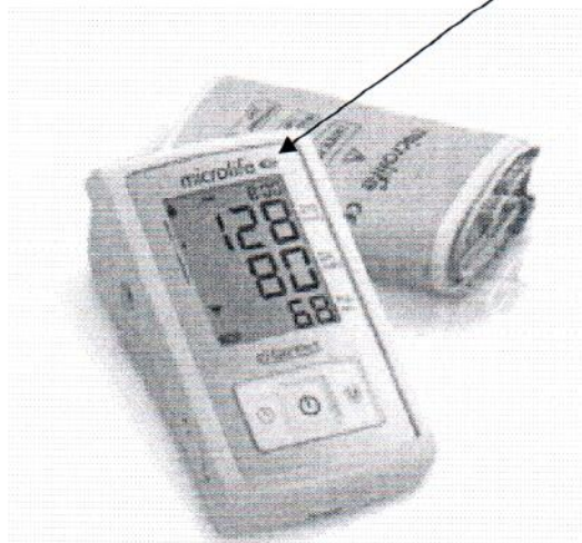
Рисунок А.1 – Схема нанесения на автоматические и полуавтоматические измерители артериального давления (приборы для измерения артериального давления) серии ВР знака поверки (клейма-наклейки).
