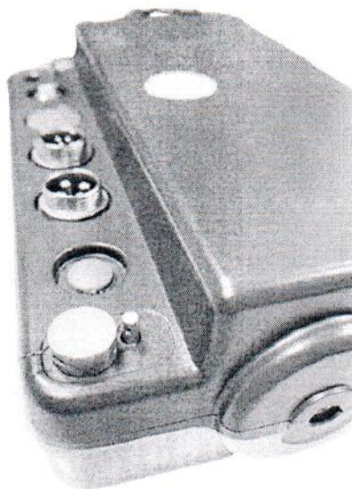
Место нанесения знака поверки (свинцовая пломба) для модели весов Титан-ТВ2.
