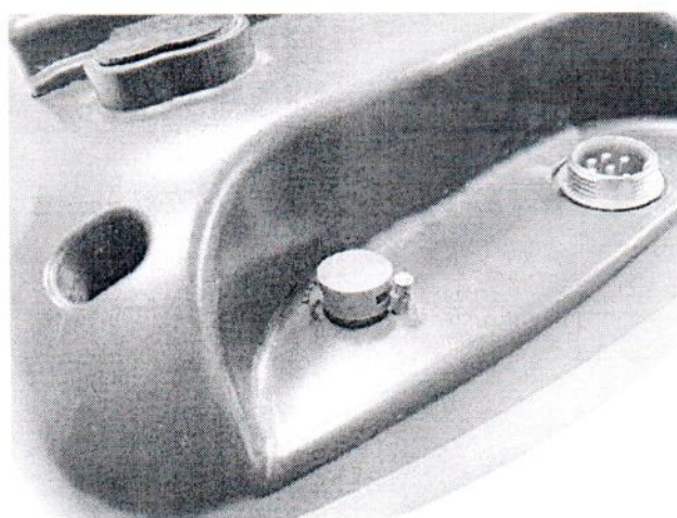
Место нанесения знака поверки (свинцовая пломба) для модели весов Титан-ТВ3.
