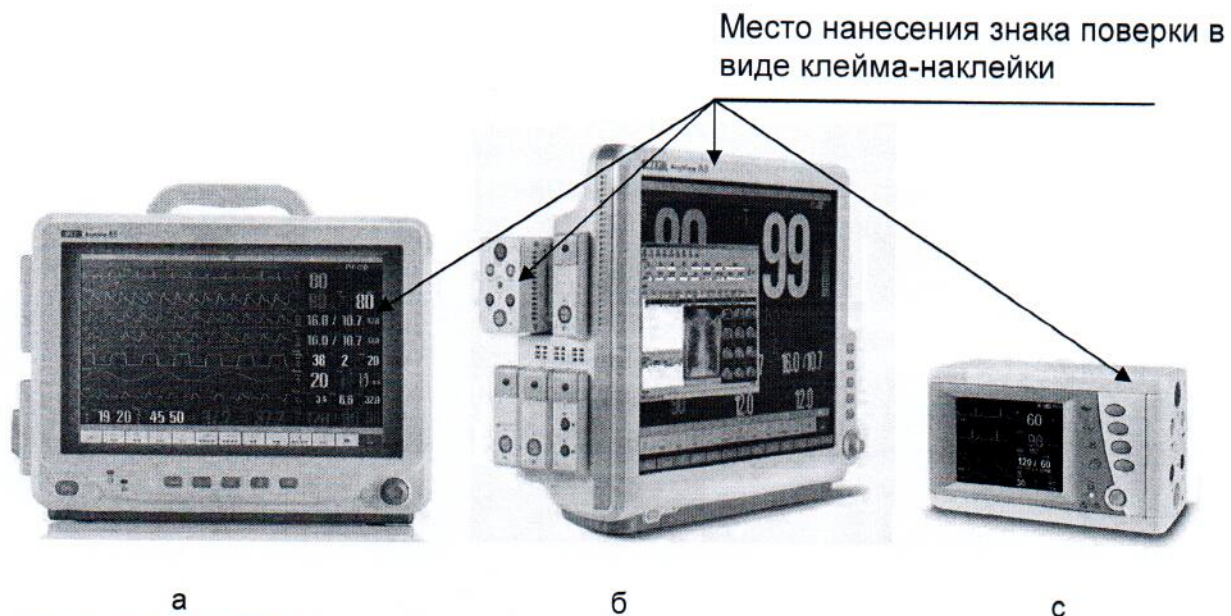
Рисунок А 1 – Место нанесения знака поверки в виде клейма-наклейки на мониторы пациента модульные серии AnyView (а - исполнение AnyView A6, б - исполнение AnyView A8, с – модуль EMS, входящий в состав мониторов)
