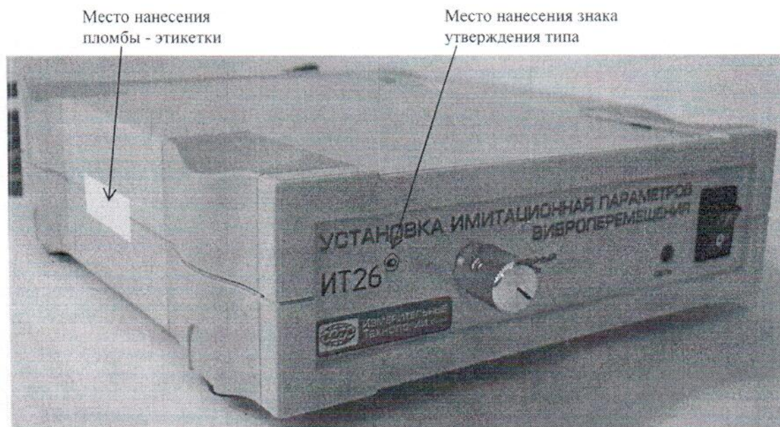
Рисунок 1 – Внешний вид установки имитационной параметров виброперемещения ИТ26
