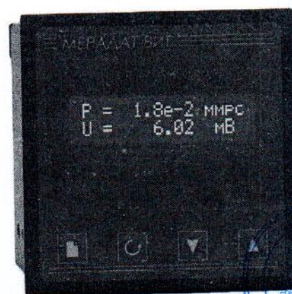
Измерительный блок вакуумметра Мерадат-ВИТ14
