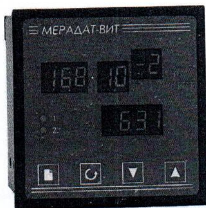
Измерительный блок вакуумметра Мерадат-ВИТ12
