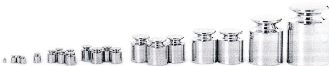
Рисунок 2 – Общий вид гирь с номинальной массой от 1 г до 50 кг цилиндрической формы с головкой из нержавеющей стали
