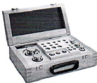
Рисунок 5 – Общий вид набора из 25 гирь с номинальными значениями массы от 1 мг до 1 кг
