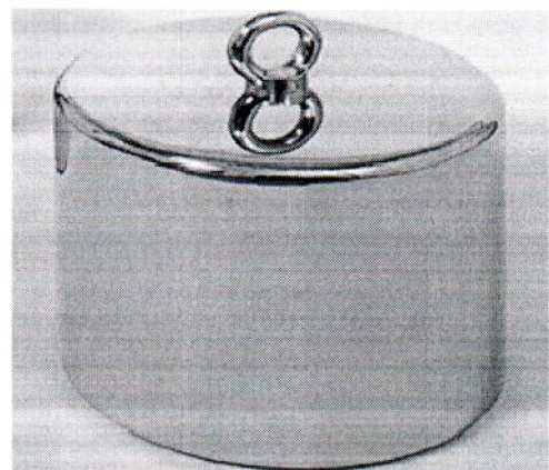
Рисунок 10 – Общий вид гирь цилиндрической формы с кольцом для захвата
