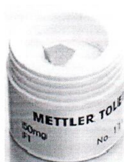
Рисунок 2 – Общий вид гирь с номинальной массой от 1 г до 50 кг цилиндрической формы с головкой из нержавеющей стали
