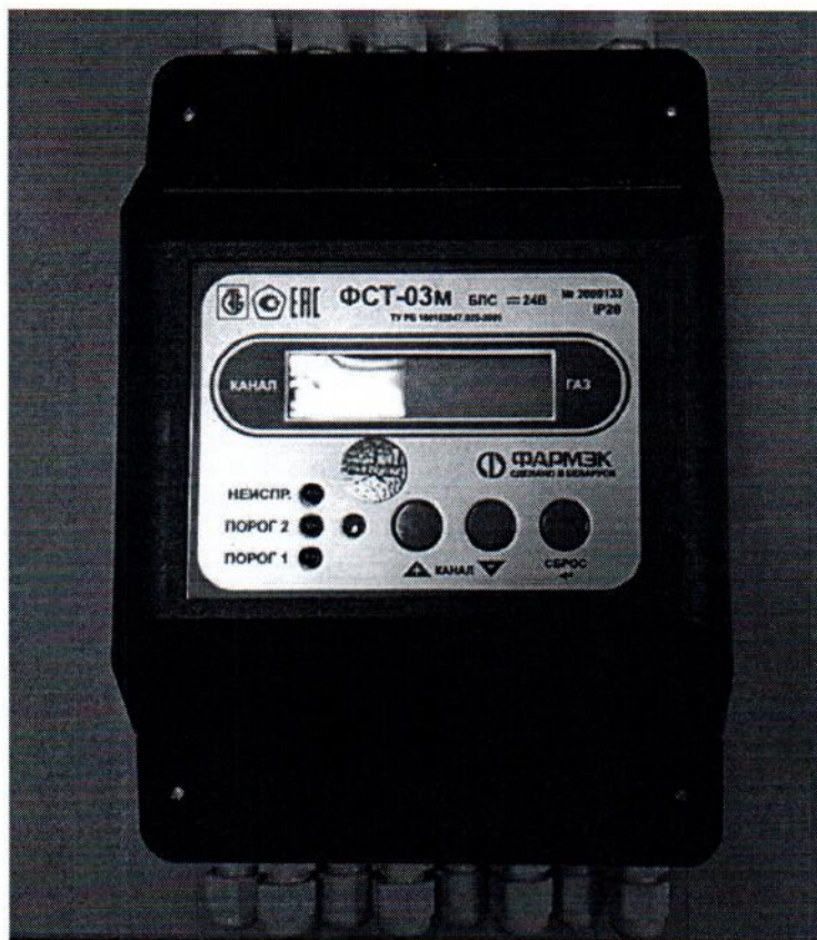
Рисунок 1а - Внешний вид газоанализатора ФСТ-03м с питанием от источника постоянного напряжения с номинальным значением 24 В.
