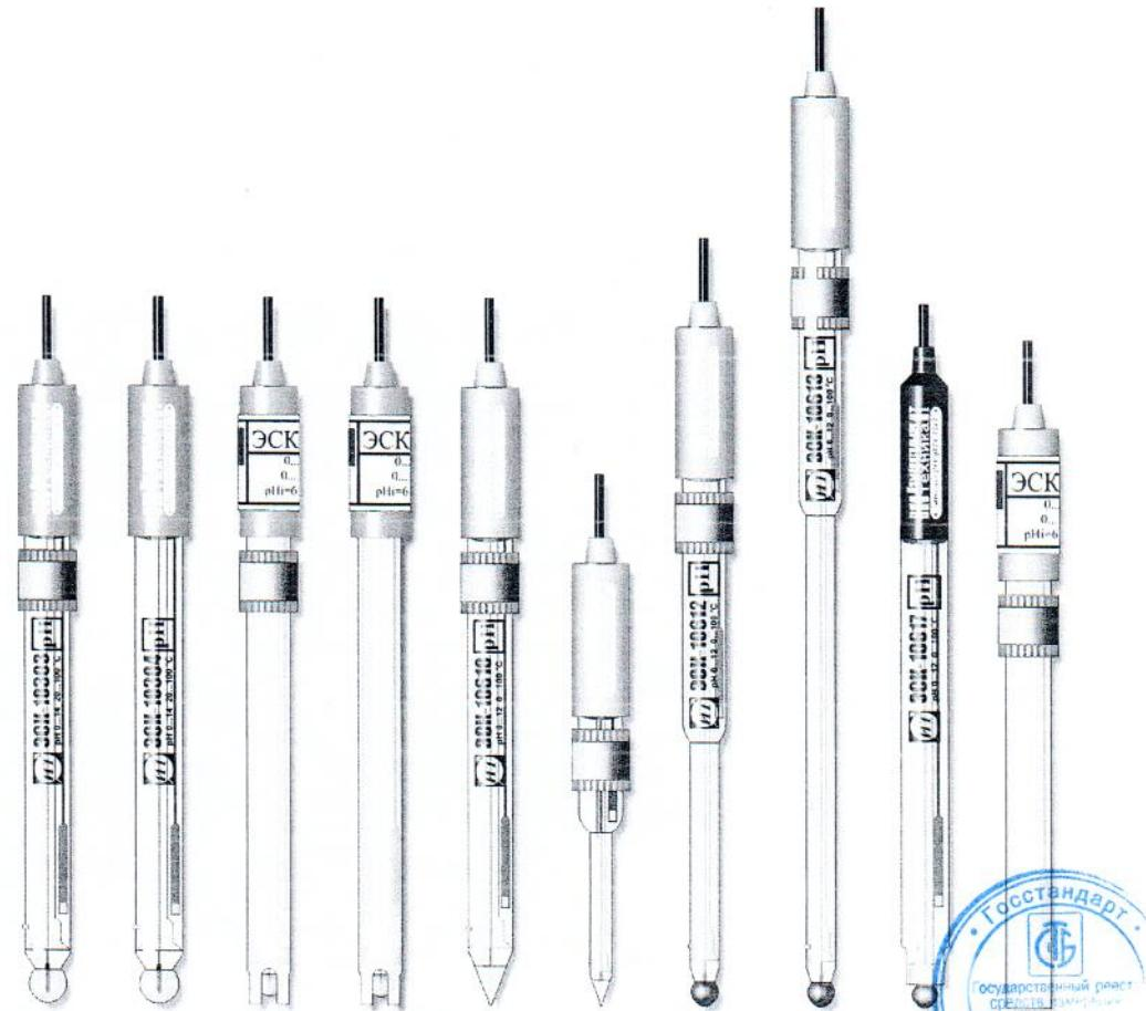
Рисунок 1 - Фотография внешнего вида электродов стеклянных комбинированных ЭСК-1.
