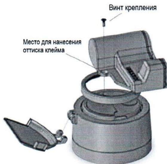
Рисунок 3А. Схема пломбировки EDC-модуля от несанкционированного доступа с указанием места для нанесения оттиска клейма
