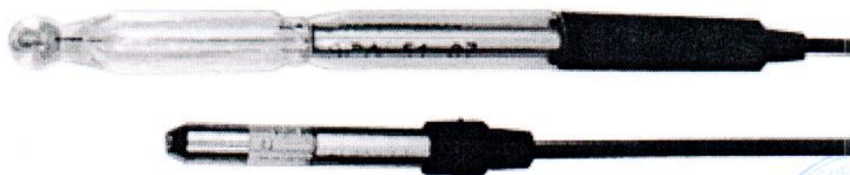
Рисунок 1 – Общий вид электрода стеклянного лабораторного ЭСЛ-51-07
