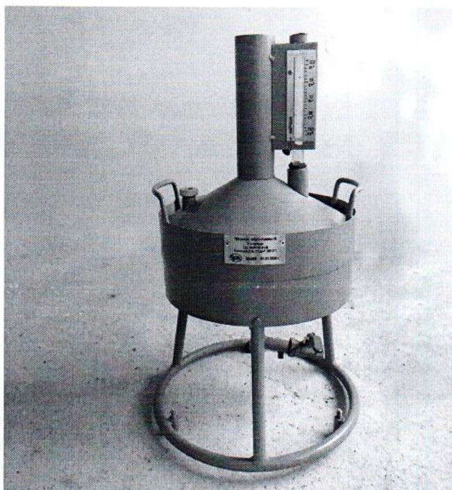
Рисунок 2 - Внешний вид мерника 2-го разряда с рамой
