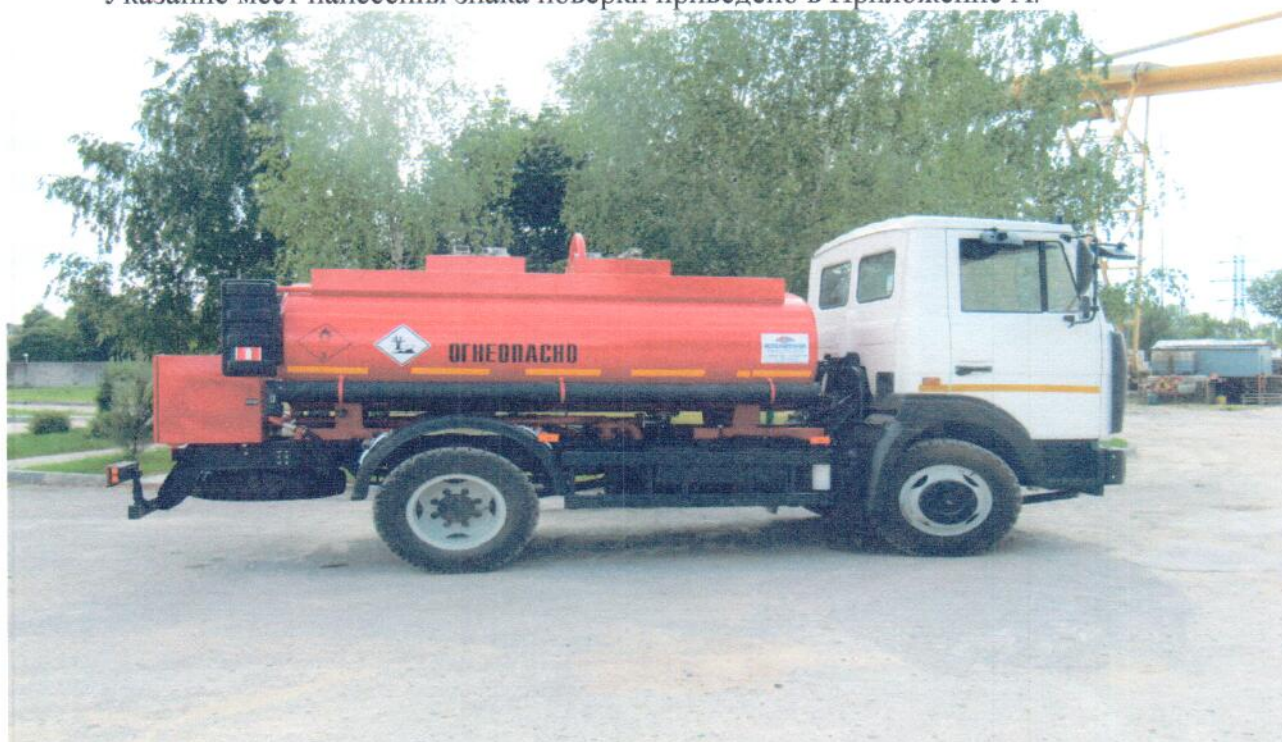
Рисунок 1. Автотопливозаправщик – АТЗ-2-4,9-4570 (АТЗ-2-4,9)
