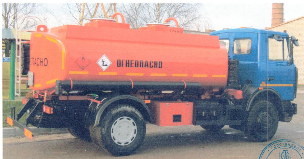
Рисунок 2. Автотопливозаправщик – АТЗ-2-11-5337 (АТЗ-2-11)
