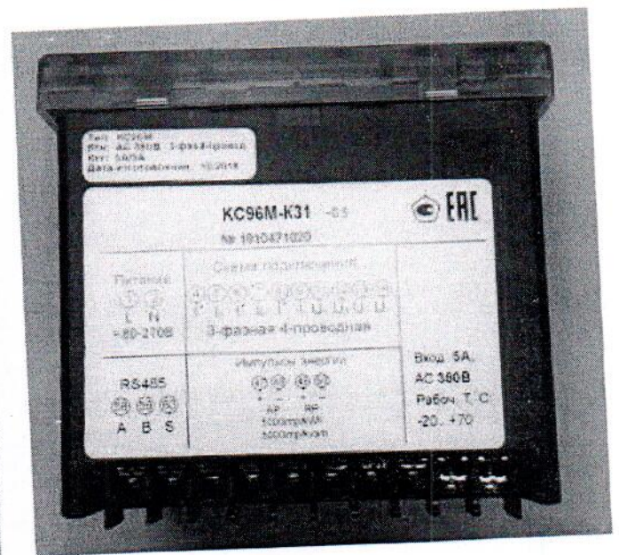
Рисунки 13 – Общий вид приборов KC96A (трехфазная модификация). Вид сзади
