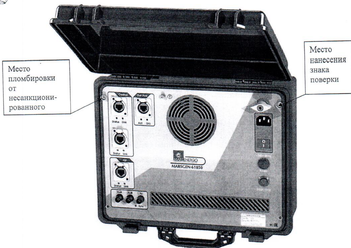
Рисунок 1 - Общий вид аппаратной части калибраторов, место пломбировки от несанкционированного доступа и обозначение места нанесения знака поверки
