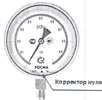
Рисунок 8 – Манометры показывающие ТМ, ТВ, ТМВ серия 21 Р.МТИ для точных измерений
