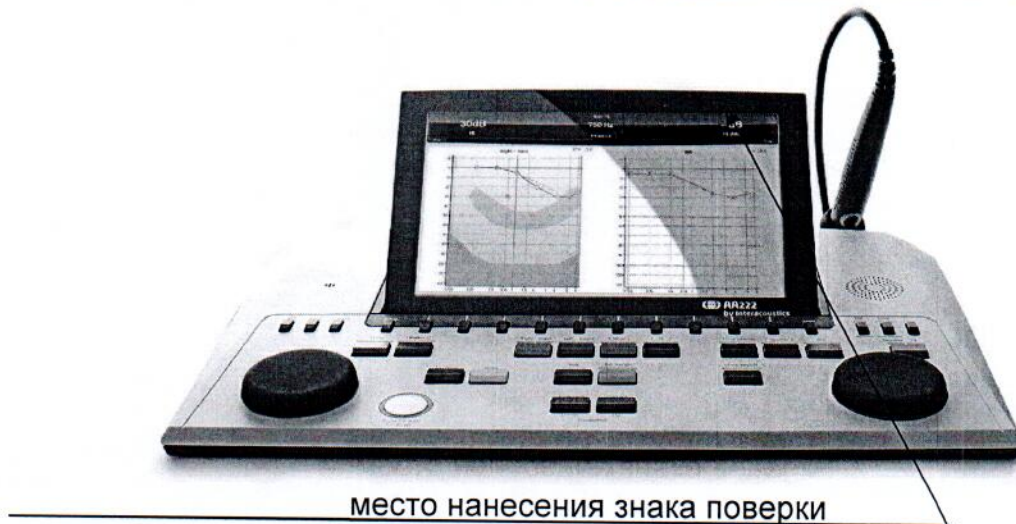
Рисунок А.2 - Место нанесения знака поверки на аудиометр импедансный АА222
