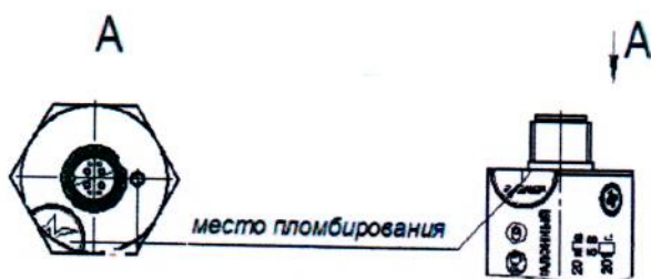
Рисунок 3 - Схема пломбировки от несанкционированного доступа ПДЭ 020
